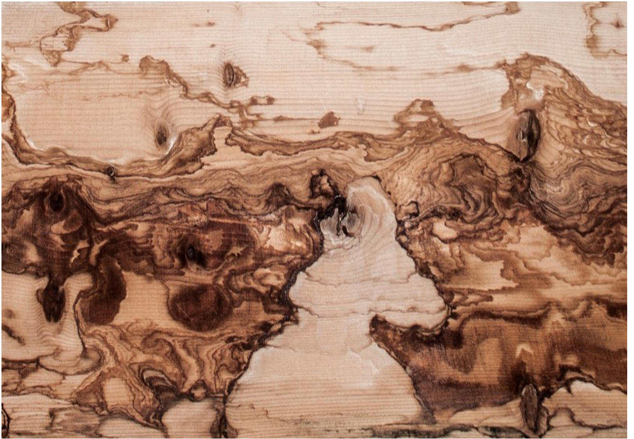
fig 22 Manchas de infiltração na madeira. Fotografia pessoal.
