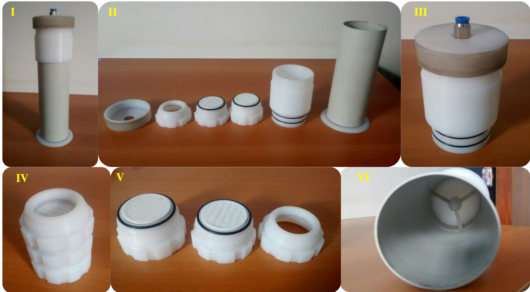
Figura 3F – Amostrador dicotômico do Tipo Gent . I - Amostrador completo; II - amostrador desmembrado; III – Alojamento da unidade de filtros empilhados (SFU); IV - SFU; V - SFU desmontado; VI - Vista interna inlet (pastilha pré-impactação)
