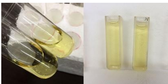
Figura 24 — Tubos de ensaio de vidro e cubetas de quartzo utilizadas na determinação do composto HMF pelo método de White (1979)
