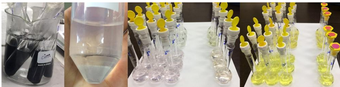
Figura 26 — Tubos de ensaio de vidro com amostras contendo carvão ativado e balões de vidro utilizados na determinação do composto HMF pelo método de Keeney e Bassette (1959) juntamente com a Zhang, J. et al. (2013)
