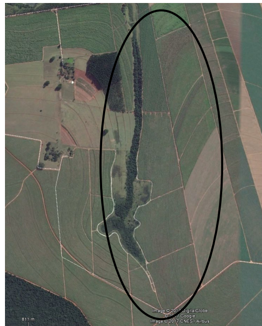
Figura 59: Margem direita com pontos críticos de erosão, sem sinais de terraceamento e curvas de nível (2017).
