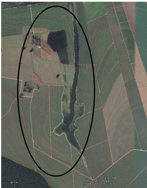
Figura 58: Margem esquerda com leves indícios de erosão laminar e sinais nítidos das curvas de nível sendo respeitadas (2017).
