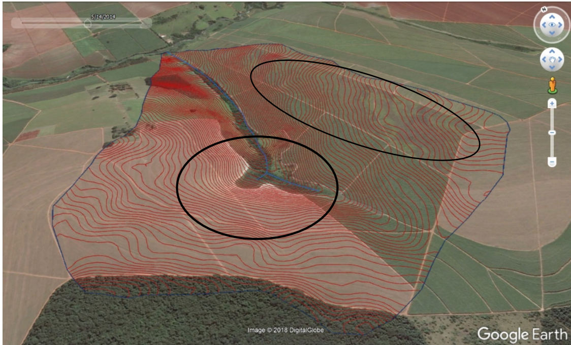
Figura 51: Imagem tridimensional da microbacia no Google Earth Pro (maio/2014) com destaque em processos erosivos na margem esquerda do Córrego Água do Sales. Elaboração: A autora (2018).
