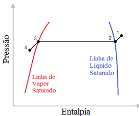
Figura 7 - Representação esquemática no diagrama pressão-entalpia dos estados termodinâmicos do fluido refrigerante ao longo do condensador.
