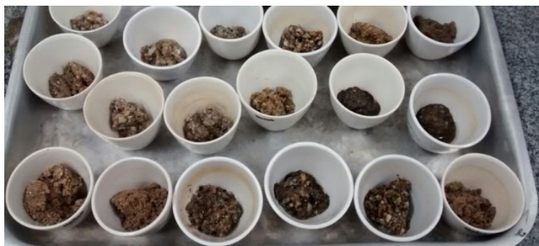
Figura 44 - Exemplo de amostras de sedimentos em cadinhos apropriados para estufa.
