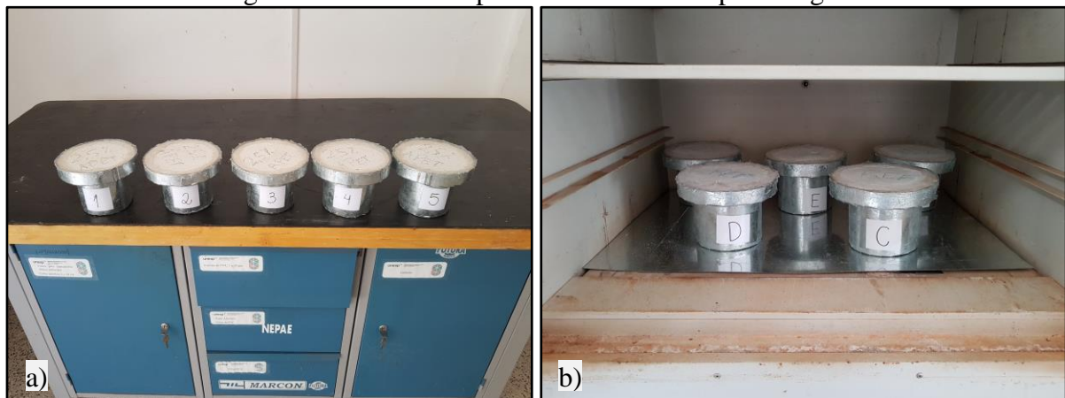
Figura 45 – Ensaio de permeabilidade ao vapor de água
