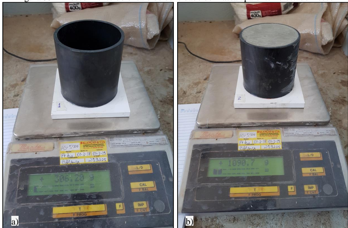
Figura 35 – Procedimento do ensaio de densidade de massa aparente no estado fresco
