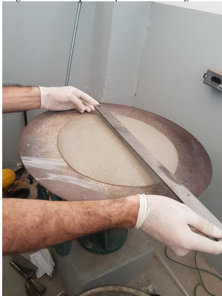
Figura 37 – Aferição do espalhamento da argamassa
