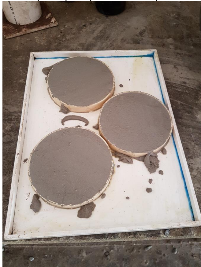
Figura 43 – Execução dos corpos de prova para o ensaio de permeabilidade ao vapor de água
