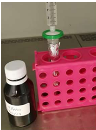
Figura 2 - Filtragem da Solução de Nanoprata Coloidal
