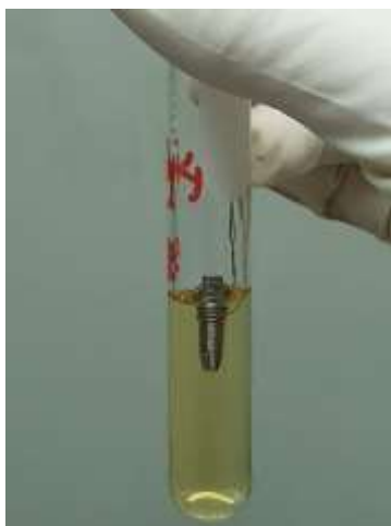
Figura 11 – Procedimento para avaliação da contaminação secundária
