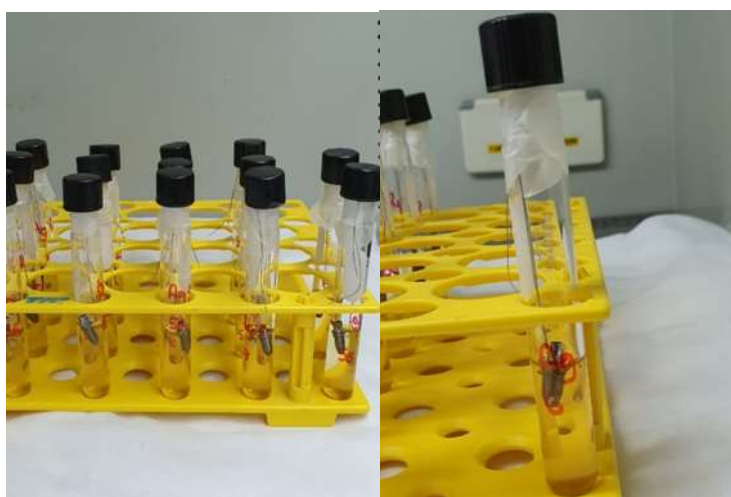
Figura 12- Procedimento de incubação dos tubos no ensaio de avaliação da contaminação secundária
