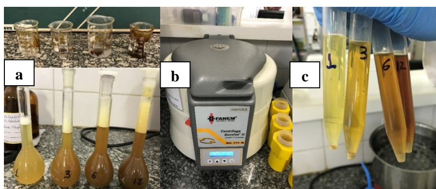
Figura 2. a) extrato mole pesado e após diluição em água deionizada; b) soluções nas diferentes concentrações para serem centrifugadas; c) extrato após centrifugação.
