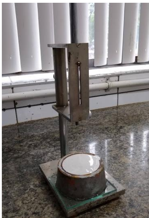
Figura 18 - Realização do teste de Vicat.
