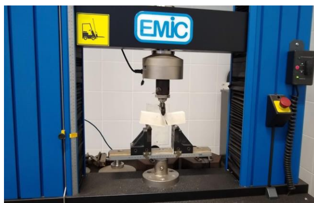
Figura 22 - Realização do ensaio de flexão.
