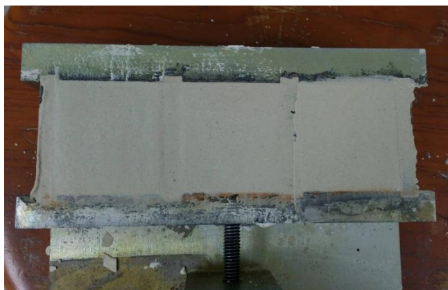
Figura 8 - Preparação dos Corpos de prova cúbicos.
