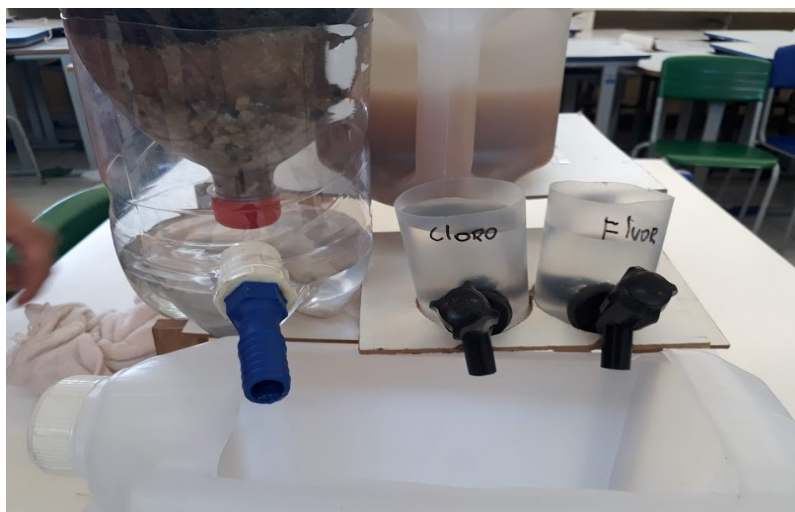
Figura 11: Compartimentos de dosagens de cloro e flúor
