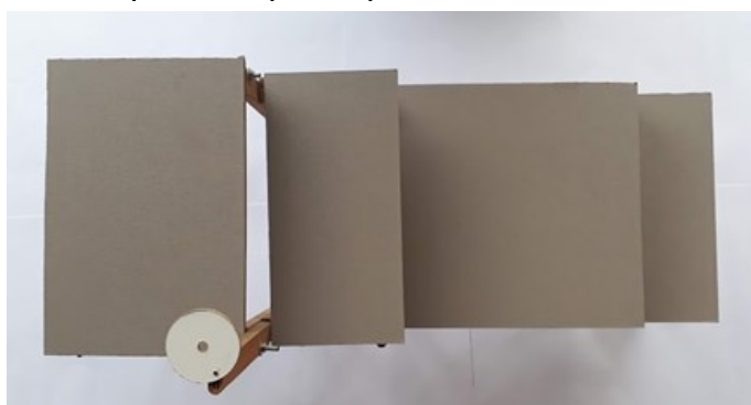
Figura 40 - Suporte do protótipo funcional da ETA com as placas de MDF.
