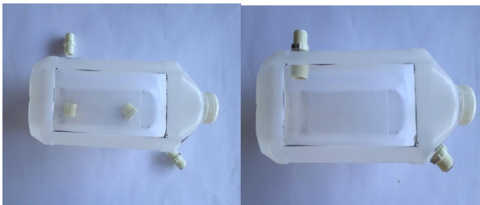
Figura 19 - Conexão dos niples do galão 2.
