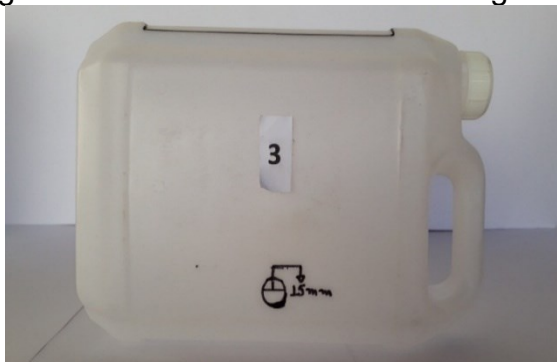
Figura 9: Corte circular na lateral do galão 3.
