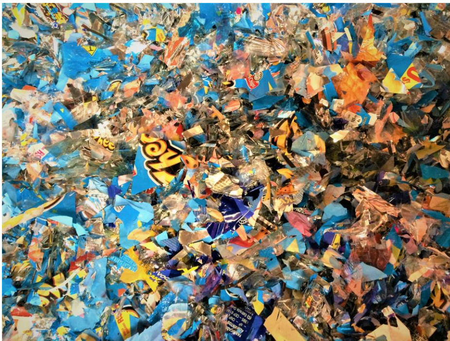
Figura 33 – Embalagens plásticas flexíveis após processo de moagem – Ecological Reciclagem (Cerqueira Cesar – SP).
