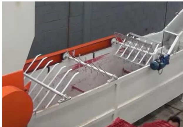
Figura 34 – Tanque de lavagem de plásticos moído
