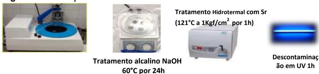
Figura 1 - Confecção das amostras de Ti
