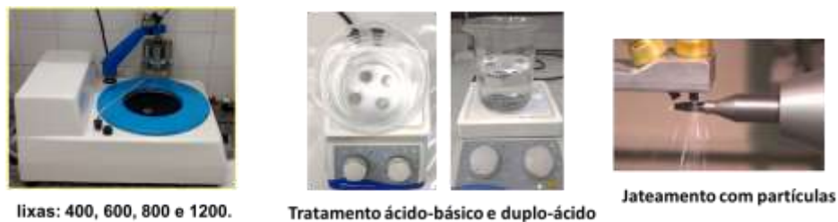
Figura 1 - Confeção das amostras de Ti cp e Ti-Al-4V
