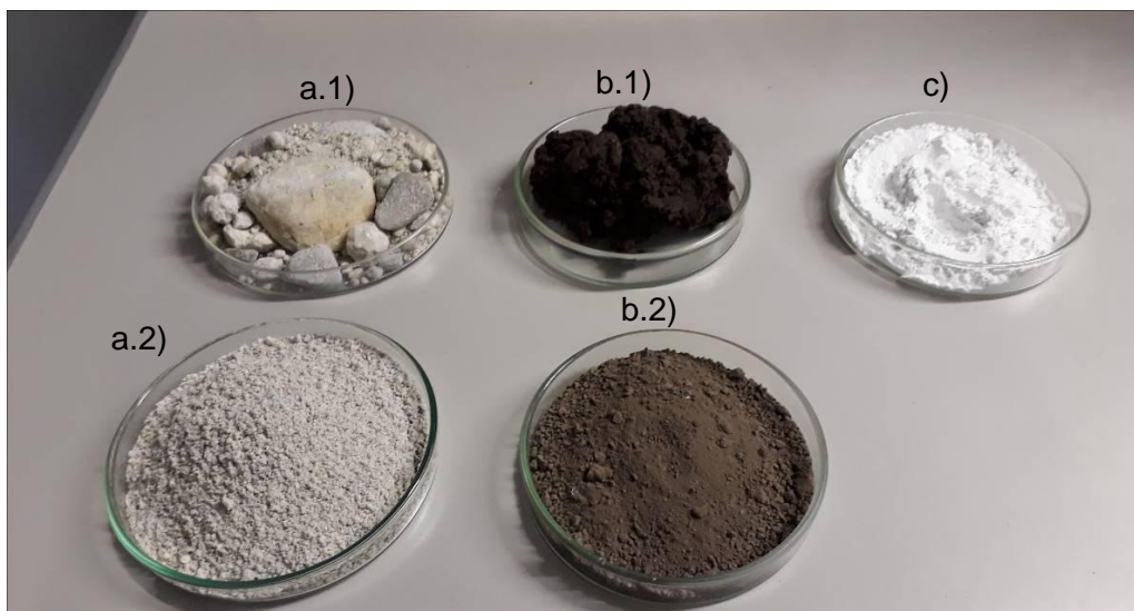
Figura 22: Amostras de resíduos inorgânicos de celulose. a.1) Grits in natura; a.2) Grits triturado; b.1) Dregs in natura; b.2) Dregs seco em estufa; c) Lama de cal in natura.
