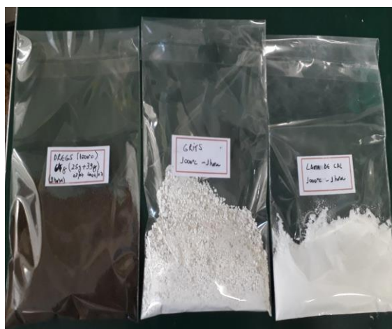
Figura 13: Resíduos de celulose secos em mufla a temperatura de 1000 °C por 1 hora.
