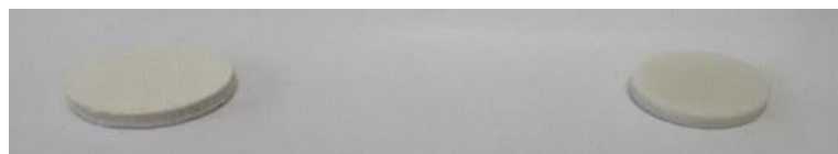
Figura 38: Pastilhas, da esquerda para direita, do vidro III (sem tratamento térmico) e da vitrocerâmica III (após tratamento térmico a temperatura de 1000 °C).
