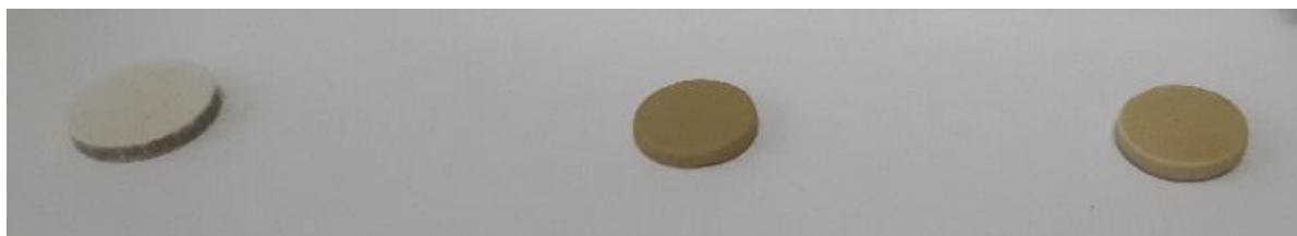
Figura 36: Pastilhas, da esquerda para direita, do vidro II (sem tratamento térmico) e da vitrocerâmica II: após tratamento térmico a temperatura de 1000 °C e após tratamento térmico a temperatura de 1090 °C.
