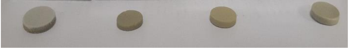
Figura 40: Pastilhas, da esquerda para direita, do vidro IV (sem tratamento térmico) e da vitrocerâmica IV: após tratamento térmico a temperatura de 892 °C, após tratamento térmico a temperatura de 1007 °C e após tratamento térmico a temperatura de 1180 °C.
