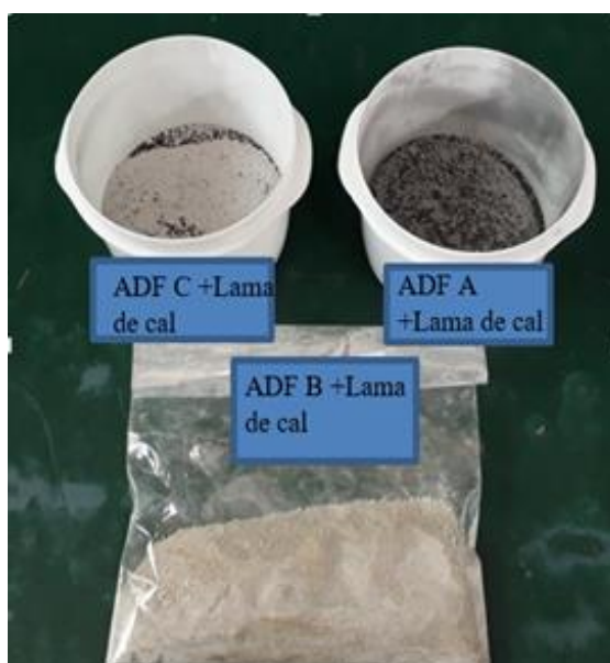
Figura 14: Mistura dos pós de ADFs das empresas A, B e C com o resíduo de celulose – lama de cal, devidamente pesado e posteriormente homogeneizado, pronto para ser levado ao forno.
