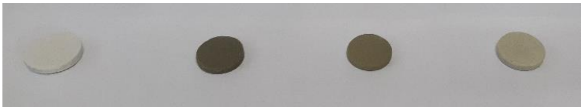
Figura 34: Pastilhas, da esquerda para direita, do vidro I (sem tratamento térmico) e da vitrocerâmica I: após tratamento térmico a temperatura de 885 °C, após tratamento térmico a temperatura de 961 °C e após tratamento térmico a temperatura de 1090 °C.
