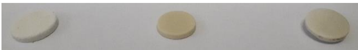
Figura 42: Pastilhas, da esquerda para direita, do vidro V (sem tratamento térmico) e da vitrocerâmica V: após tratamento térmico a temperatura de 1050 °C e após tratamento térmico a temperatura de 1190 °C.
