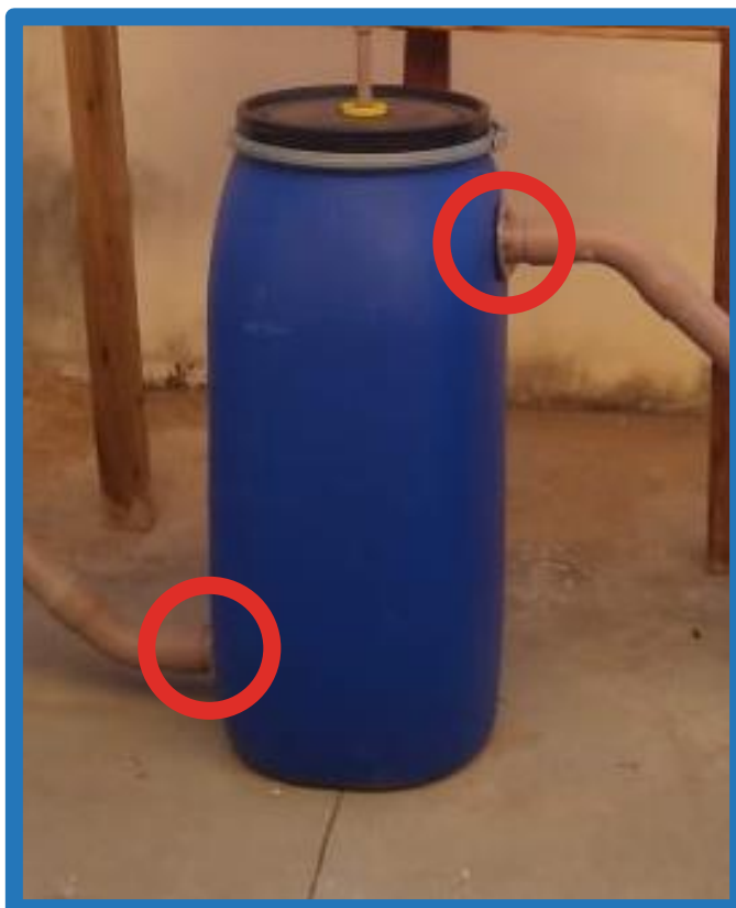
Figura 3 - Posição dos Flanges/Próprio Autor
