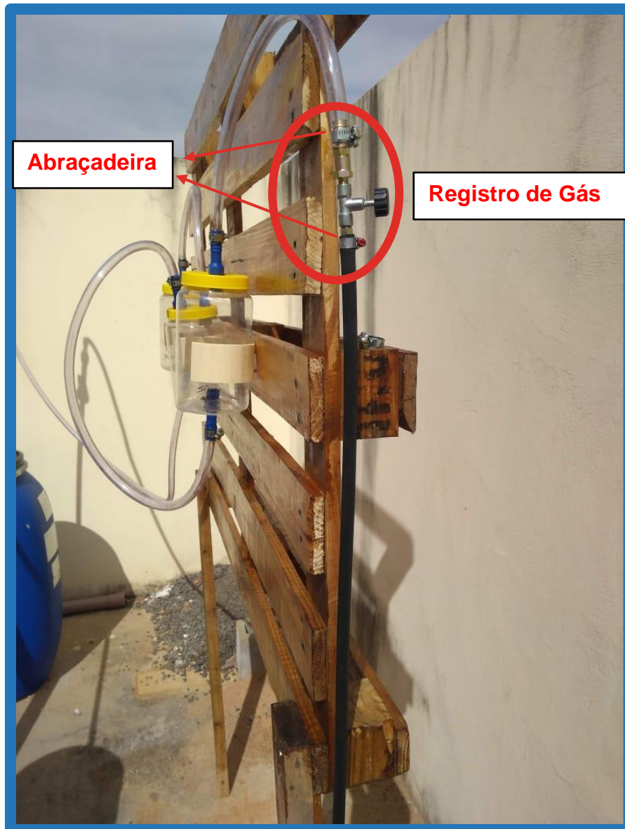
Figura 16 - Registro e Mangueira de gás/Próprio Autor
