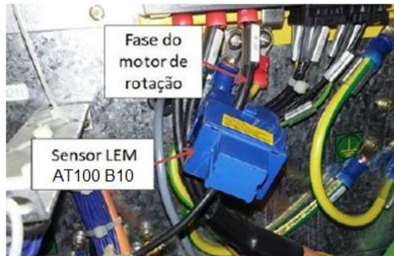
Figura 17 - Montagem do sensor de potência acoplado à entrada do motor principal do centro de torneamento CNC.
