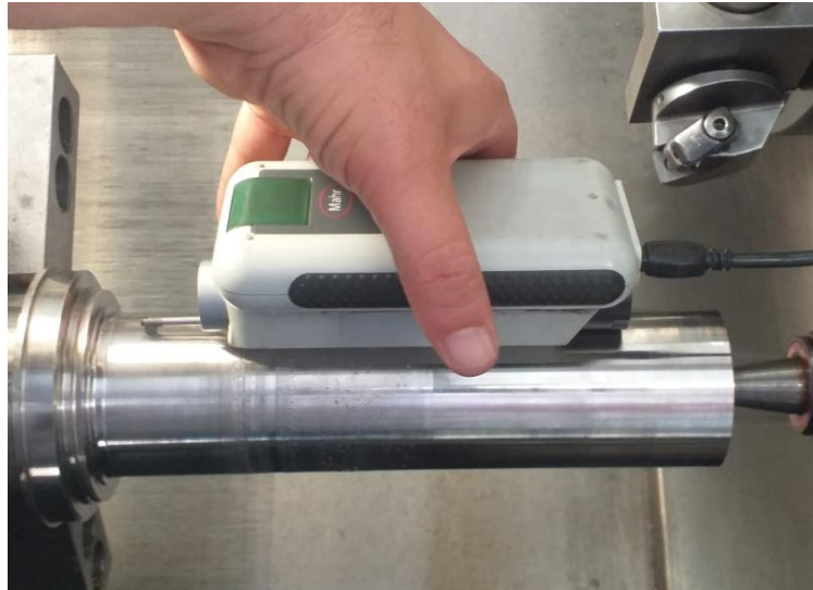
Figura 23 – Medição da rugosidade da peça na máquina após usinagem.
