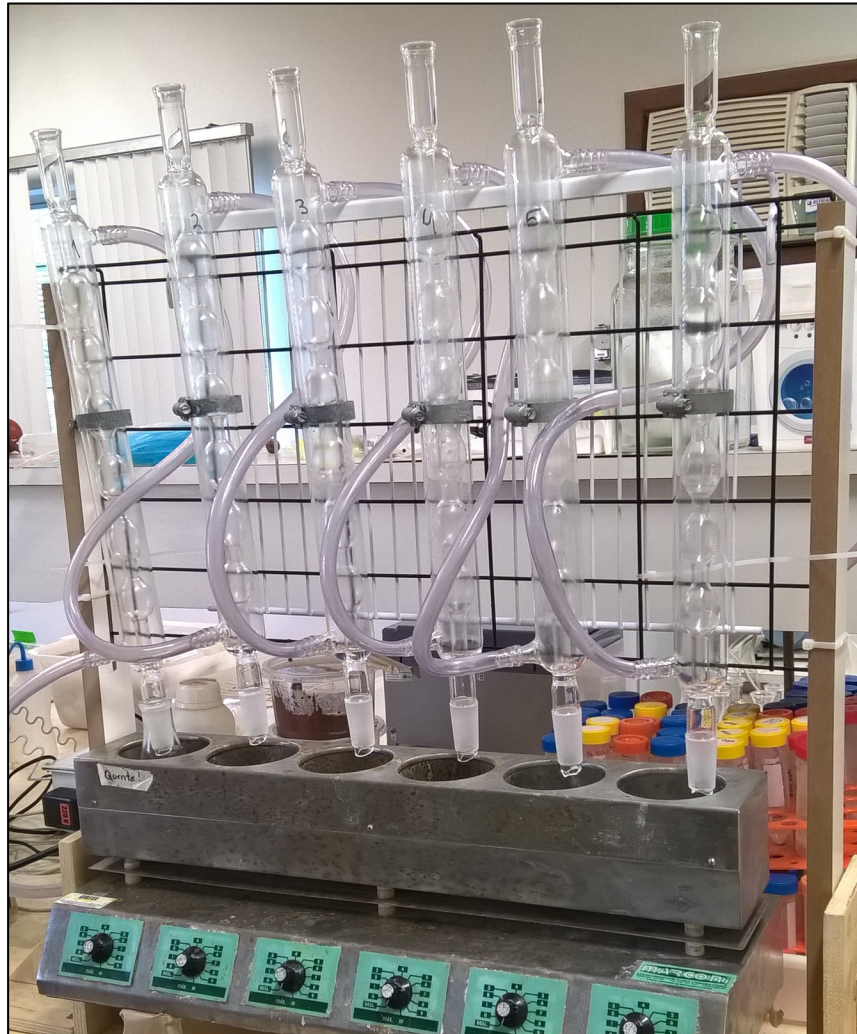
Figura 10. Estrutura para oxidação em sistema de refluxo.
