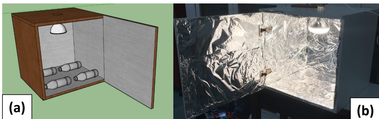
Figura 12. (a) Projeto e (b) construção da câmara de foto oxidação.
