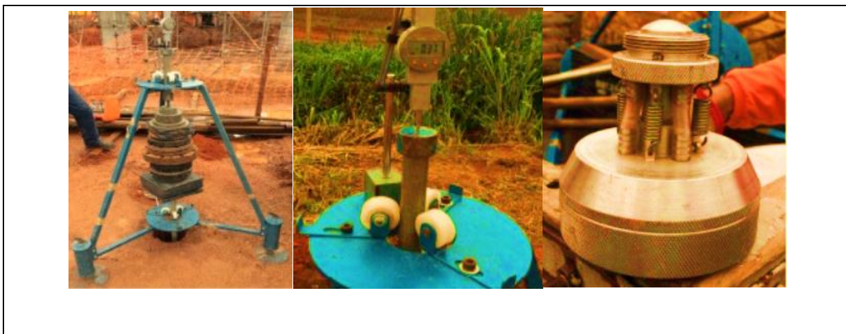
Figura 17. Expanso-colapsômetro e seus componentes (Louro et al., 2016)
