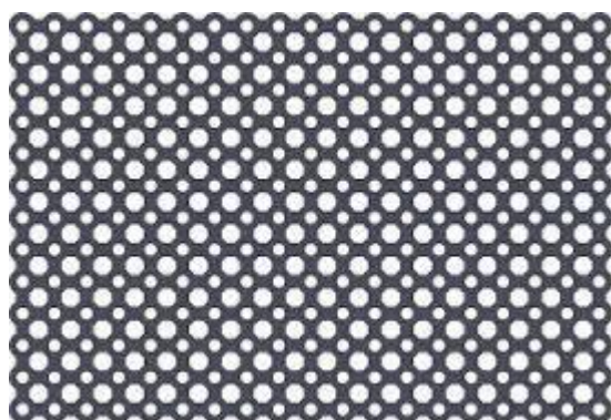
Figura 3 - Malha de titânio utilizada para reconstrução de assoalho orbitário
