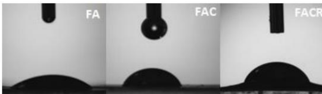
Figura 20. Gota de líquido padrão sobre a superfície dos filmes de alginato e couve reticulados, em t=30s.
