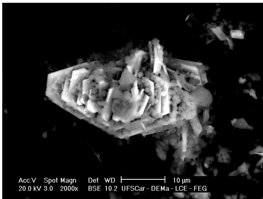
Figura 22. MEV da amostra FAU/Cu 2+ com aumento de 2000x.
