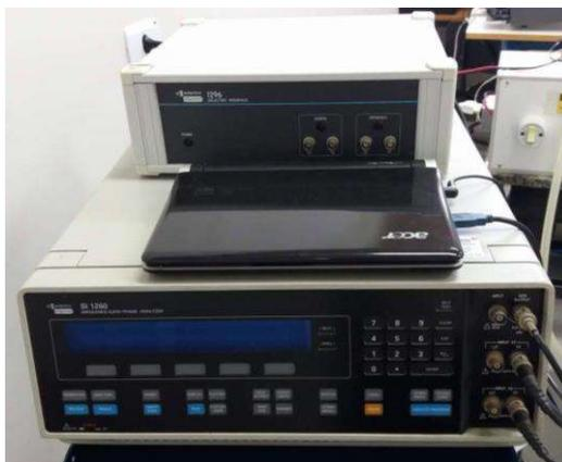
**Fig. 36:** Analisador de impedância Solartron SI 1260 com interface dielétrica SI 1296.
