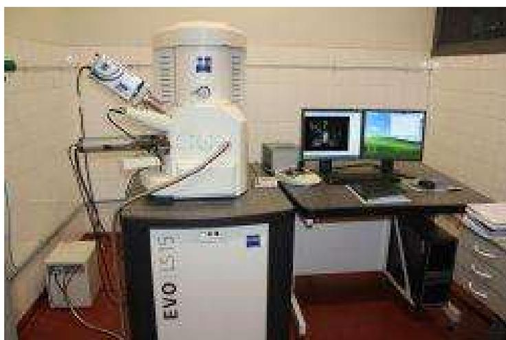
**Fig. 31:** Foto do Microscópio Eletrônico de Varredura Carl Zeiss modelo EVO LS 15.
