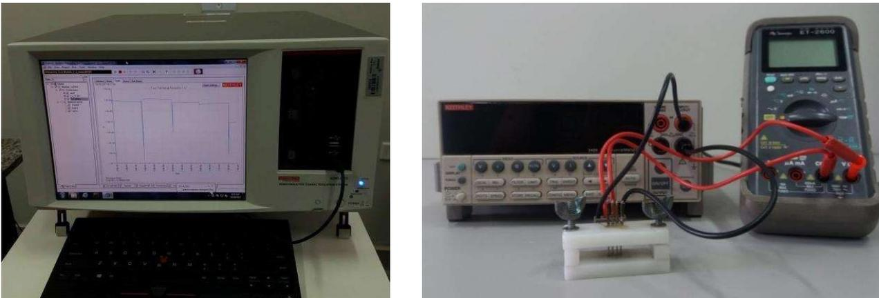
**Fig. 32:** Equipamentos utilizados: Keithley SCS 4200 e um sistema de medida de quatro pontas home made utilizando Keithley 2420 e um multímetro.
