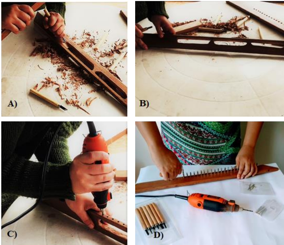
Figura 19. Alterações na estrutura inicial da harpa. A) e B) Abertura das fendas; C) Perfuração dos orifícios para as cordas; D) Substituição dos parafusos por pinos para harpa.
