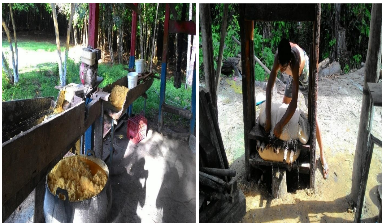
Figuras 40 e 41: Mandioca passando pelo processo de trituração e prensa para se tornar farinha.
