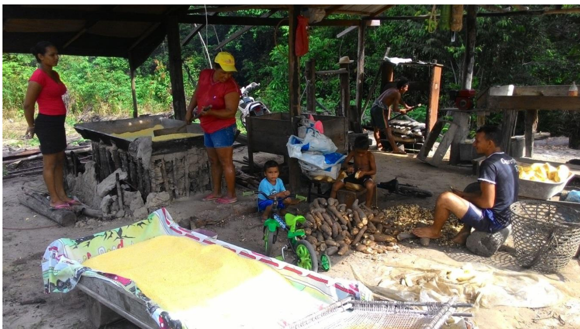
Figura 43: Processo de produção da farinha no seu estágio inicial, em que a mandioca é descascada, colocada de molho, moída, prensada, torrada e, ao final, a farinha está pronta no tabuleiro.
