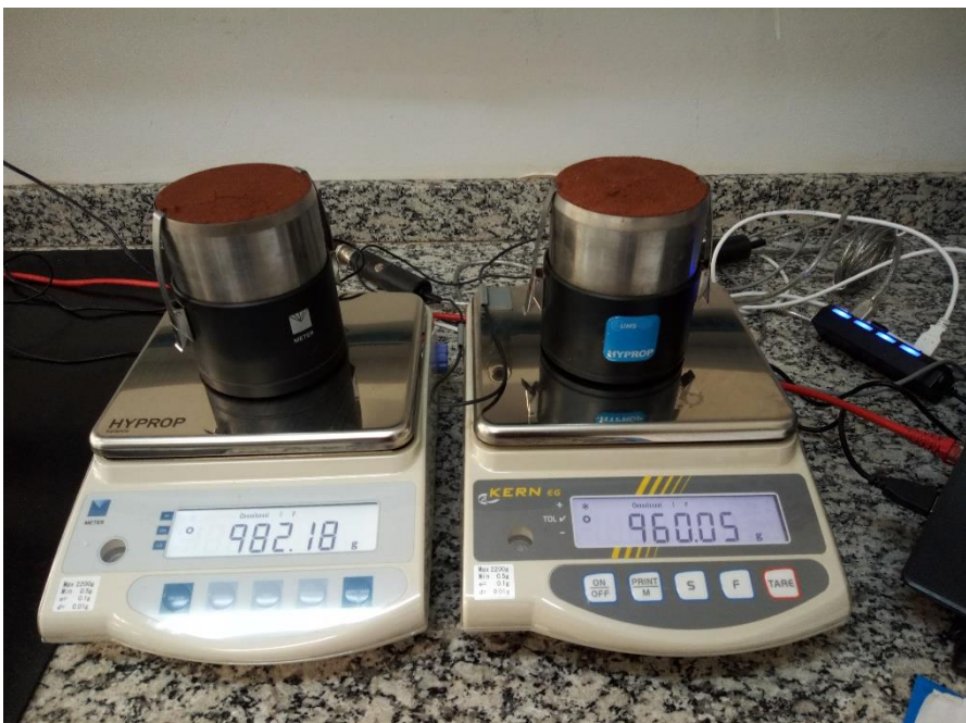
Figura 10: ensaio através do método de evaporação HYPROP em andamento. Foto: Gabriel Leite.
