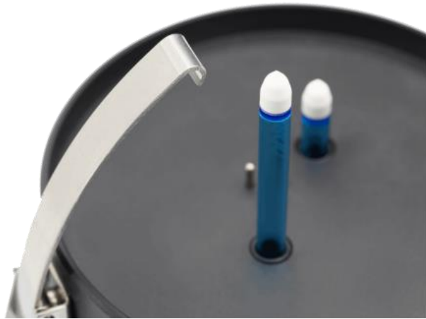
Figura 8: Detalhe dos tensiômetros (long e short) ligados ao corpo do aparelho HYPROP. Retirado de https://www.ffi.nz/product/hyprop-2/ . Acesso em 29/03/2019 as 22h44.
