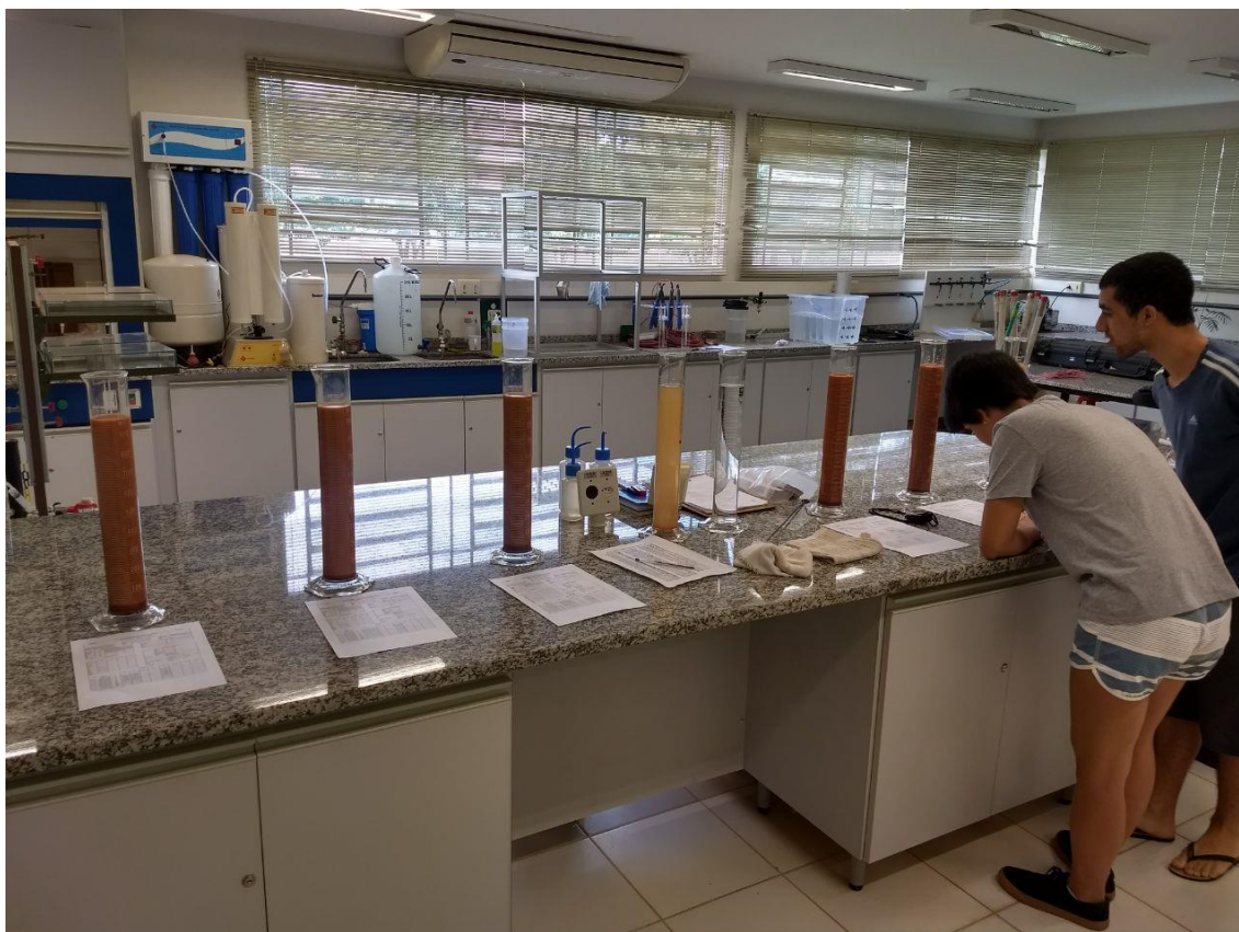
Figura 7: Ensaio de Granulometria Conjunta realizada no RAIH. Foto: Guilherme Faleiro Silva Campos
