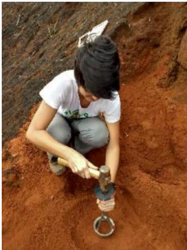
Figura 5: Detalhe do procedimento para coleta de amostra indeformada. Foto: Gabriel Cardoso Leite.
