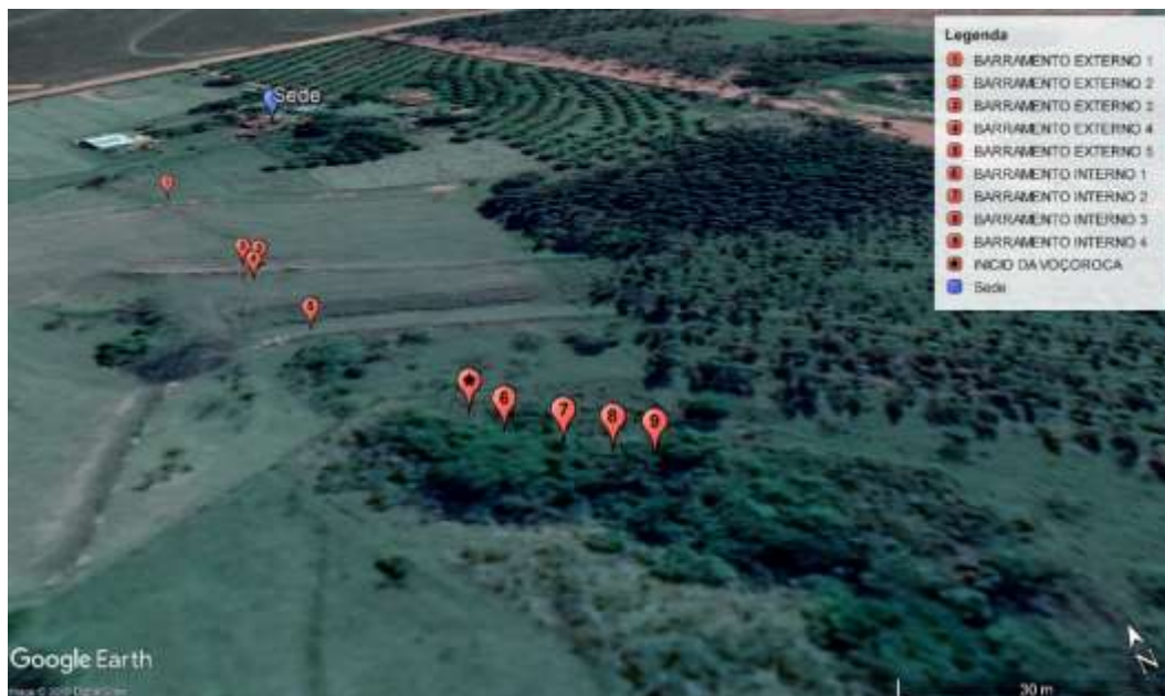
Figura 35 – Pontos onde foram instaladas as paliçadas de bambus.
