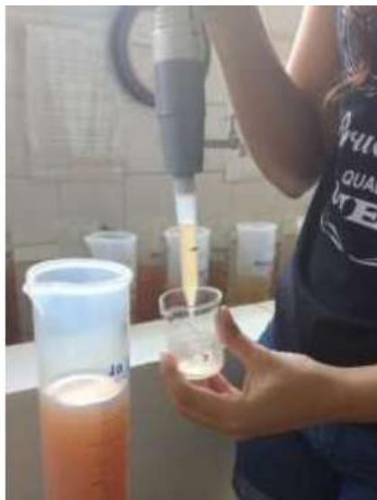
Figura 16 – Pipetagem de amostra de solo para determinação da porcentagem de argila.
