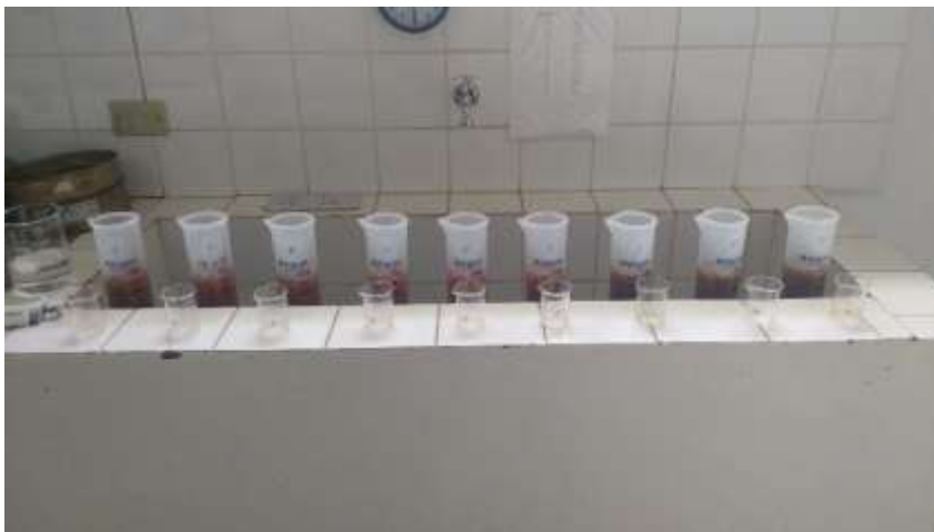
Figura 15- Provetas com argila e Silte em processo de decantação.
