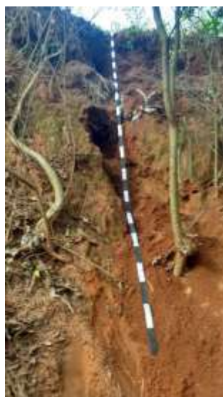
Figura 06- Utiliza o de fita m trica para medi o dos horizontes pedol gicos do perfil de solo.
