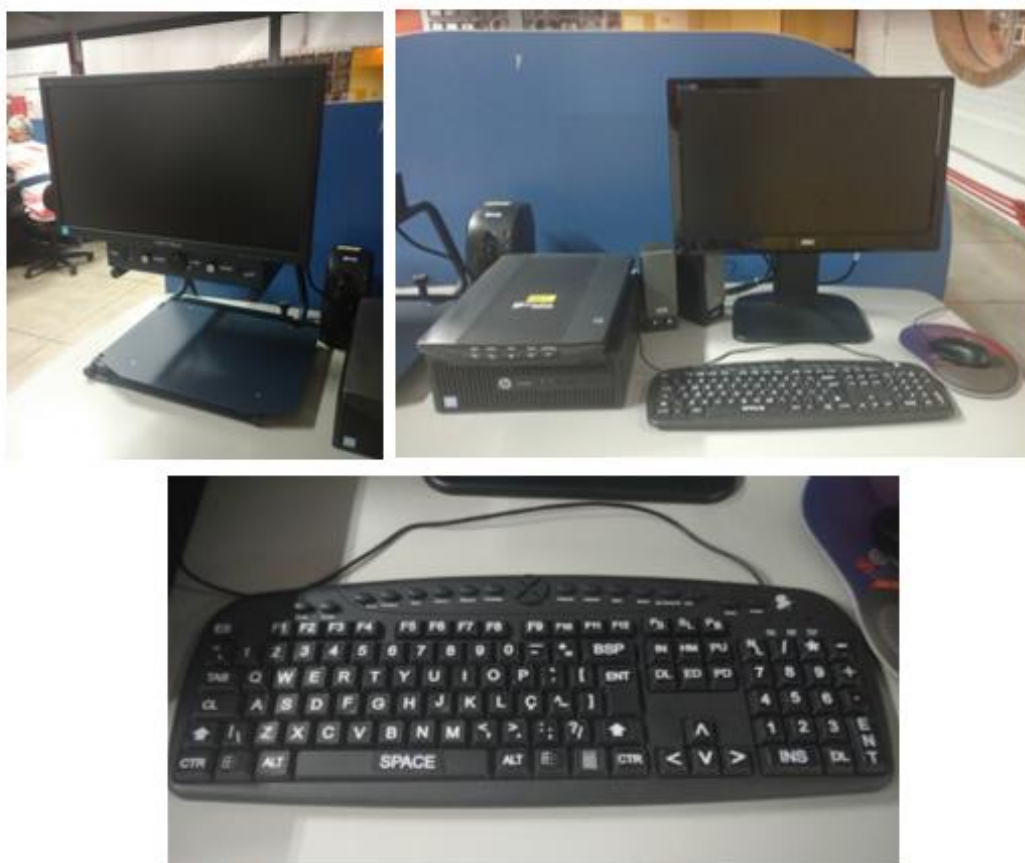
Figura 25: Tela ampliadora de imagens para pessoas com baixa visão; scanner para conversão de textos em áudios; teclado de alto contraste e símbolos ampliados
