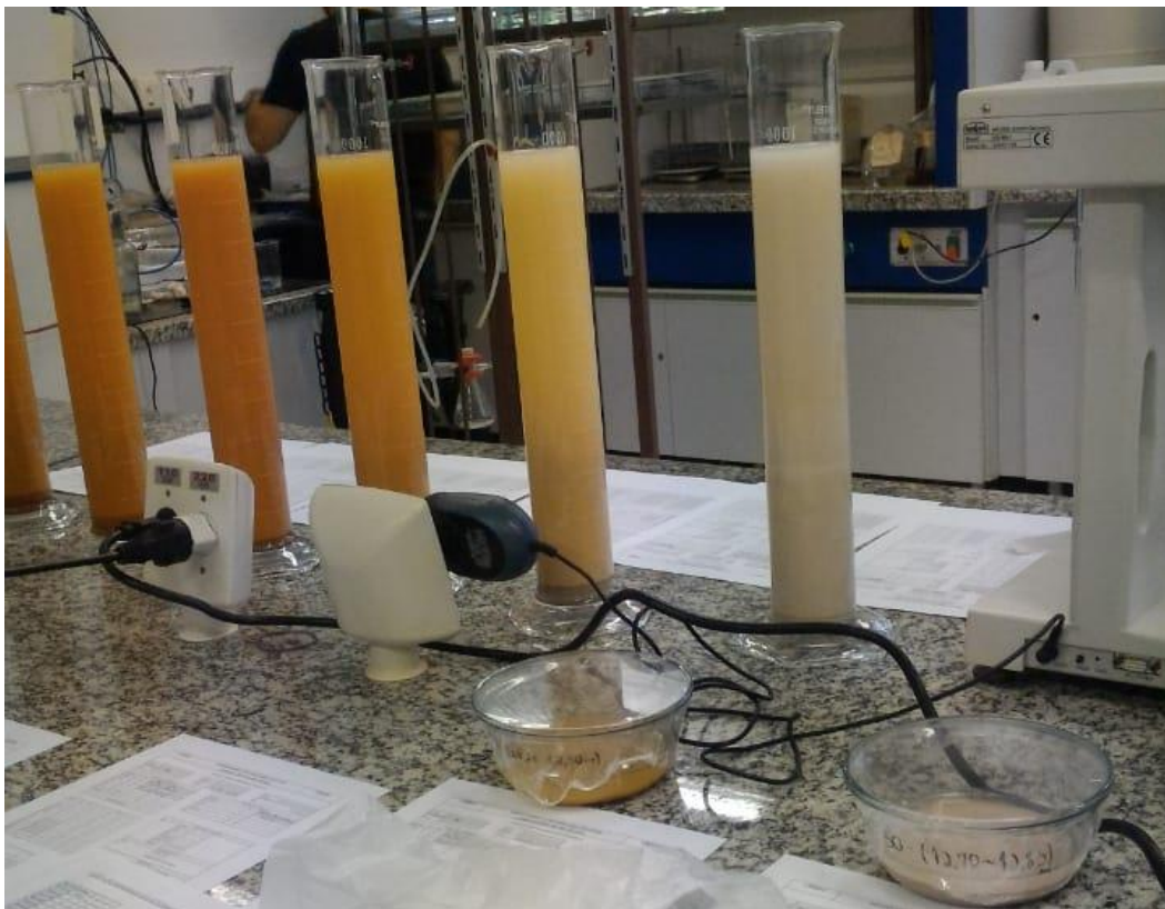
Figura 4. 3: Arranjo das amostras analisadas pelo método da sedimentação no ensaio de granulometria conjunta. Fonte: Acervo Pessoal.
