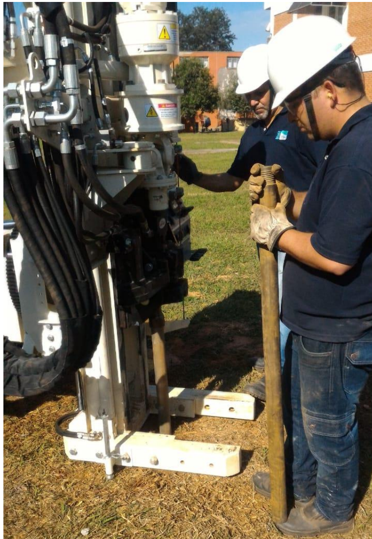
Figura 4. 1: Amostragem realizada com o equipamento Geoprobe por meio do método Direct Push . Fonte: Acervo Pessoal.
