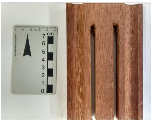
Figura 5.7 - Peça de madeira utilizada para auxiliar os cortes das amostras, feita sob medida para a serra utilizada. Fonte: Acervo pessoal (2018).
