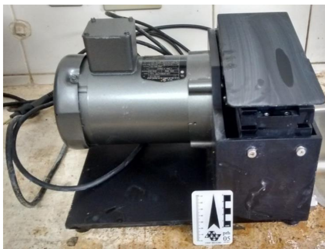
Figura 5.6 - Serra da ASC Scientific, utilizada para o corte das amostras. Fonte: Acervo pessoal (2018).
