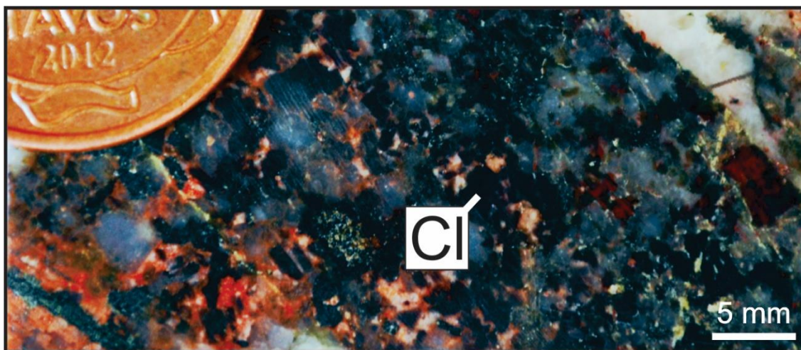
Figura 18: Hospedeira granítica com intensa alteração clorítica pervasiva e geração de cristais grossos de clorita verde escura. Legenda: Cl: clorita.
