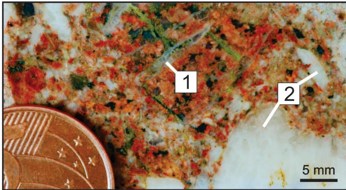
Figura 24: Silicificação evidenciada por (1) vênulas e (2) bolsões de quartzo, ambos de coloração branca leitosa.
