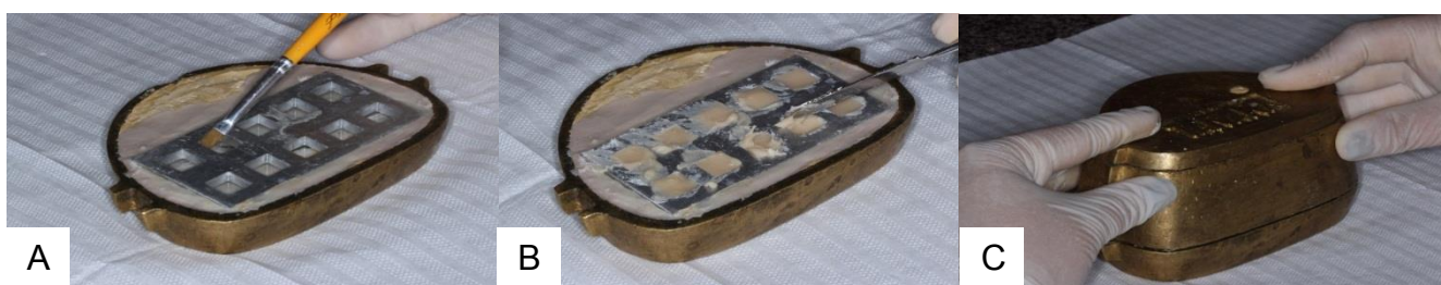
Figura 3 – A- Isolamento da matriz metálica. B- Colocação do material RAA. C- Fechamento da mufla.
