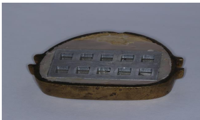
Figura 2 – Matriz metálica inclusa em mufla.
