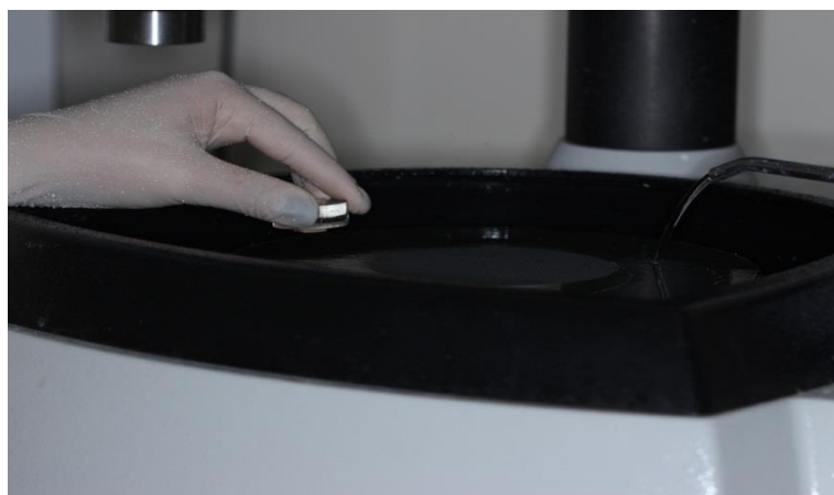
Figura 6 – Amostra sendo polida em politriz automática.
