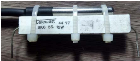
Figura 21 – Carga resistiva acoplada ao sensor
