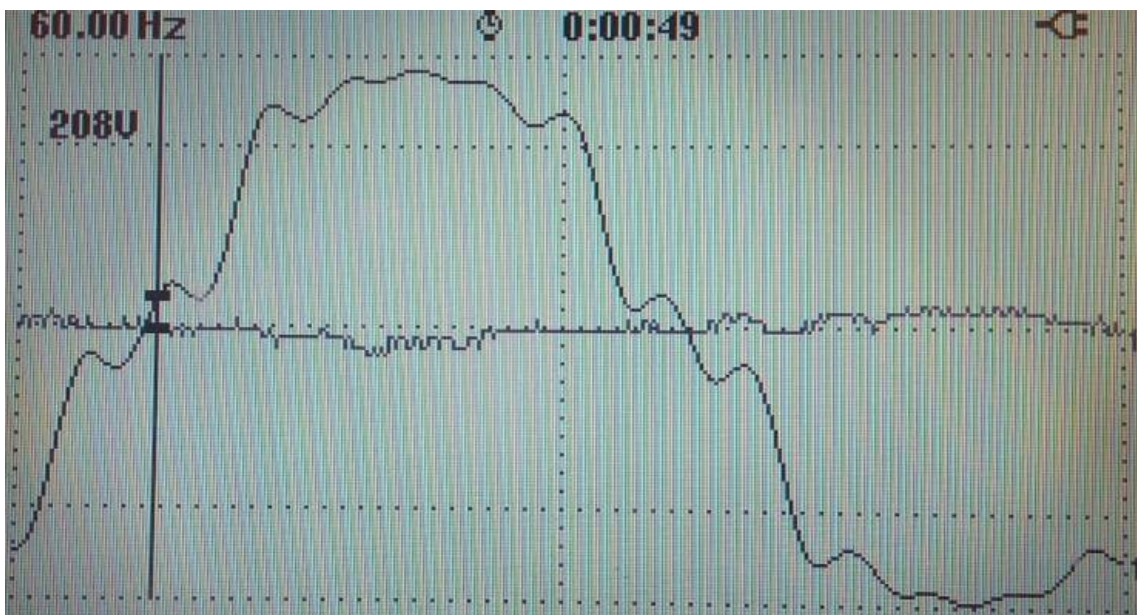
Figura 17 – Onda IEC 77A classe 2 gerada através da fonte AMX-345
