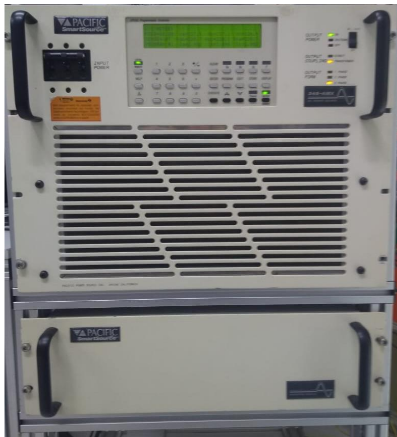
Figura 13 – Fonte de tensão programável AMX-345
