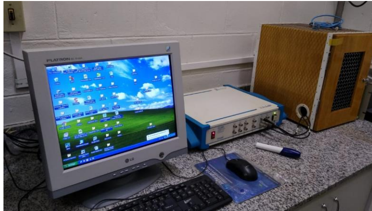
Figura 14: Equipamento completo para realizar os ensaios de corrosão.
