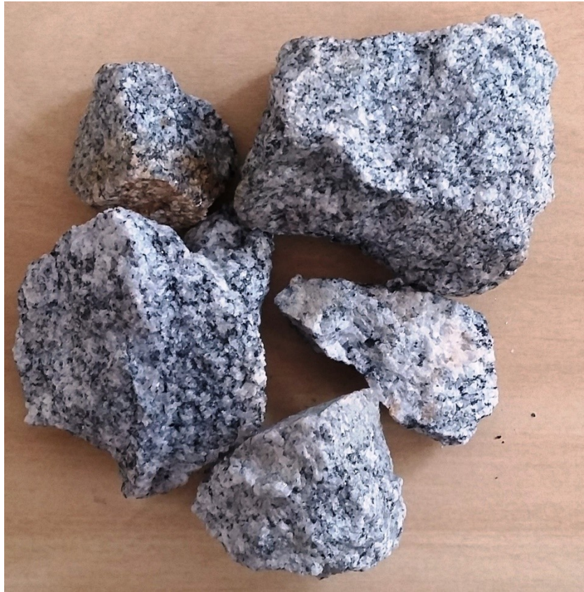
Figura 29. Fragmentos de rocha fresca encontrados durante a escavação do anel 2193 (21/08/2015) e correspondente a unidade geológica 5R (gnaisse migmatítico).
