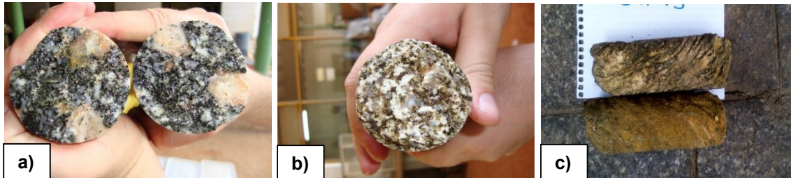
Figura 14. a) rocha granítica em grau de alteração A1/A2; b) rocha granítica em grau de alteração A3. Notar a coloração esbranquiçada do feldspato e a perda do brilho dos minerais; e c) rocha gnáissica em grau de alteração A4. Observar o aspecto terroso e desagregável do material. Fonte: adaptado de Metrô-SP, apud Monteiro & Rocha (2017).
