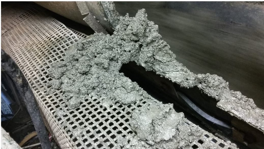
Figura 30. Solo siltoso micáceo cinza, transportado na esteira durante a escavação do anel 2267 (10/09/2015) e correspondente à unidade geológica 5SR (solos residuais).
