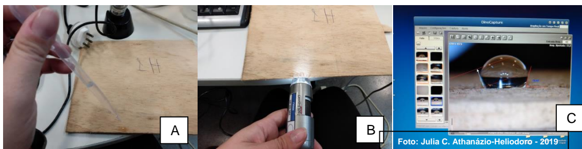
Figura 4 – Molhabilidade das lâminas: A - Gotejamento da água destilada sobre a lâmina; B - Fotografia digital; C - Medição dos ângulos laterais
