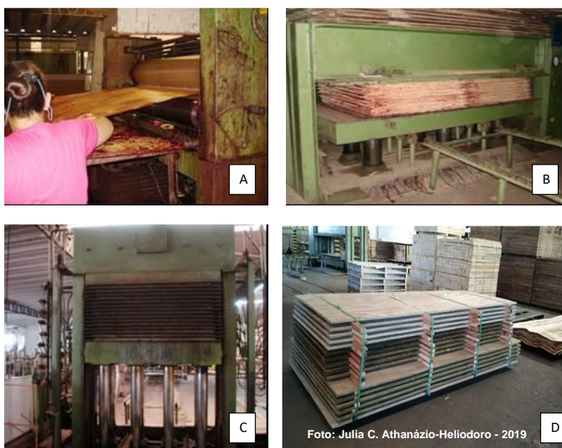
Figura 1 –Etapas do processo de fabricação de painéis compensados: A - aplicação de cola nas lâminas; B - pré-prensagem a frio; C - prensagem a quente; D - painéis logo após a prensagem a quente
