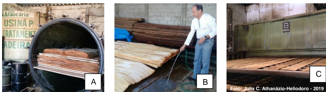
Figura 3 – A- Tratamento de lâminas sob pressão em autoclave na Usina Araucária; B - Umidificação das lâminas prévia ao tratamento; C - Secagem em secador industrial das lâminas preservadas
