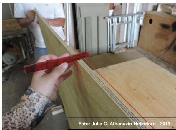
Figura 3 – Medição do empenamento em uma das direções do painel compensado
