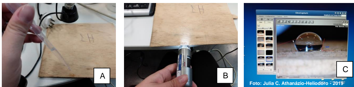
Figura 5 – Molhabilidade das lâminas: A - Gotejamento da água destilada sobre a lâmina; B - Fotografia digital; C - Medição dos ângulos laterais
