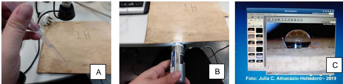
Figura 2 – Molhabilidade das lâminas: A – Gotejamento da água destilada sobre a lâmina; B – Fotografia digital; C – Medição dos ângulos laterais
