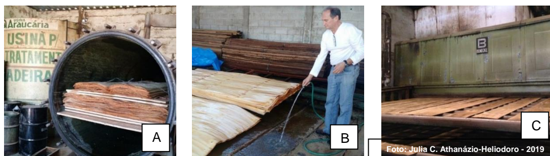
Figura 2 –A - Tratamento de lâminas sob pressão em autoclave na Usina Araucária; B - Umidificação das lâminas previamente ao tratamento; C - Secagem das lâminas preservadas em secador industrial
