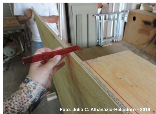
Figura 3 – Medição do empenamento nos painéis compensados
