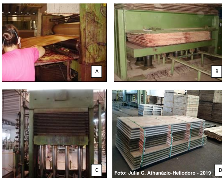
Figura 1 – Etapas do processo de fabricação: (a) aplicação de cola nas lâminas; (b) pré-prensagem a frio; (c) prensagem a quente; (d) painéis logo após a prensagem a quente
