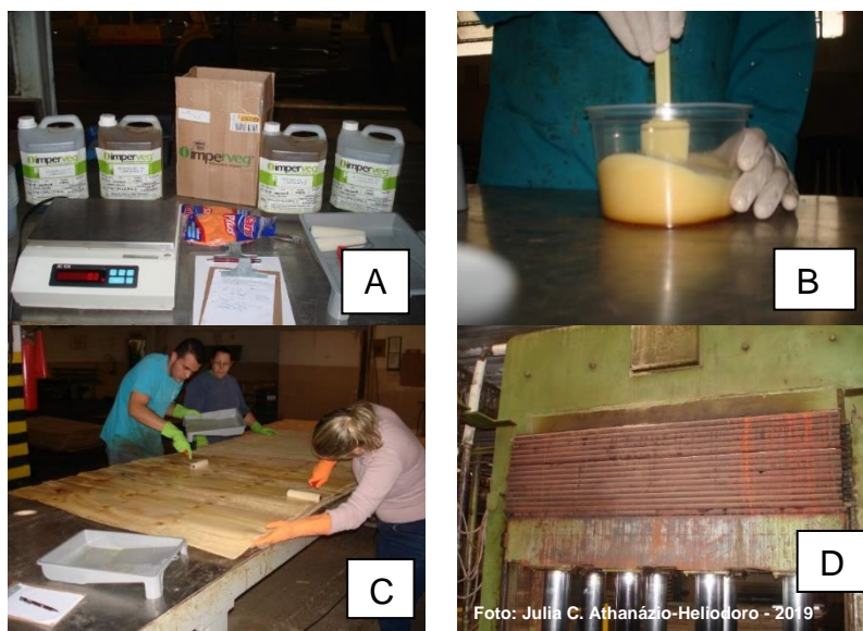
Figura 2 – Etapas do processo de fabricação de painéis compensados colados com resina poliuretana: A - Pesagem dos componentes da resina; B - Mistura dos componentes da resina; C - Aplicação manual de cola nas lâminas; D - Prensagem a quente dos painéis
