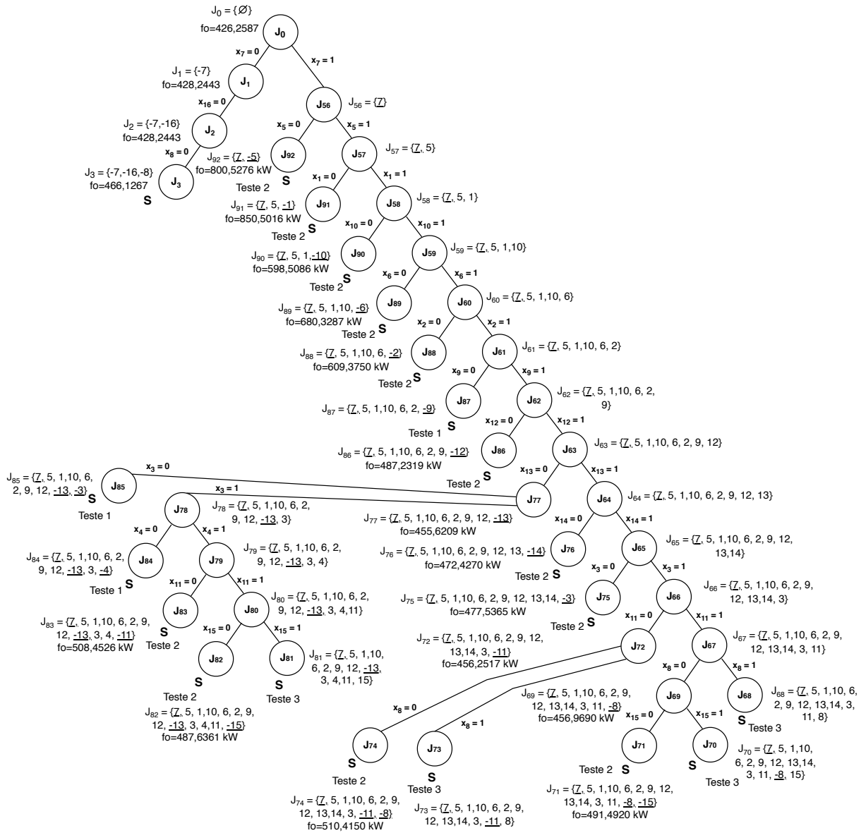
Figura 13 - Árvore de branch and bound para o sistema de 14 barras - Terceira parte.
