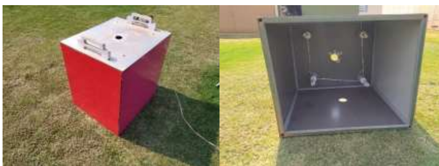
Figura 5 - “Light box” utilizada para padronização da luminosidade e altura das fotos
