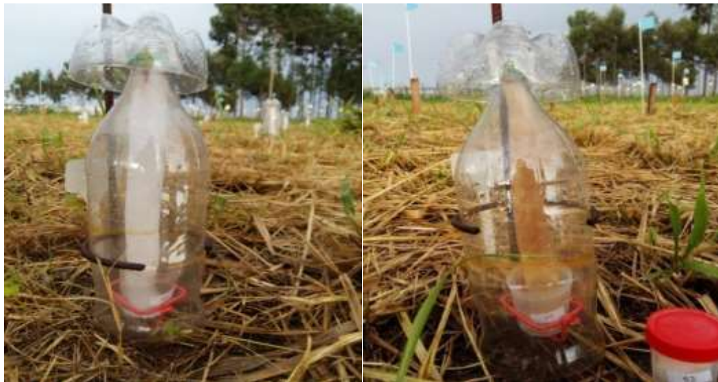
Figura 5 – Amostragem de \text{NH}_3 em câmara tipo semi-aberta. Fonte: Arquivo pessoal.
