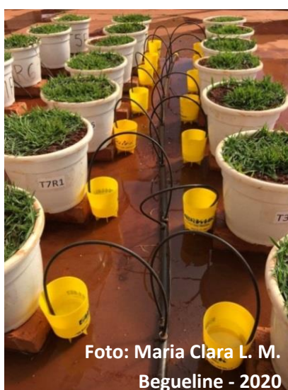
Figura 6 - Teste de uniformidade de distribuição de água por gotejamento - Botucatu, SP, 2020
