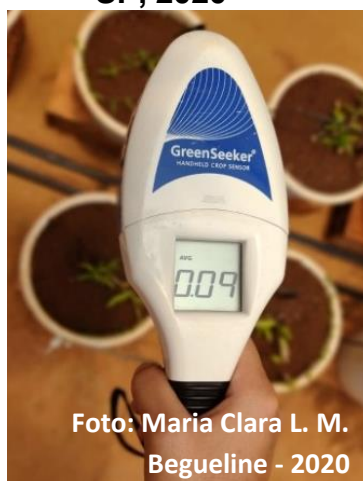
Figura 8 - Leitura do índice de vegetação por diferença normalizada (NDVI) com aparelho portátil GreenSeeker Handheld Crop Sensor (Trimble®) - Botucatu, SP, 2020
