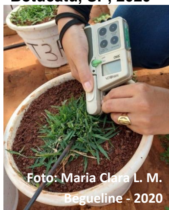
Figura 10 - Medição da intensidade da coloração verde com medidor SPAD - Botucatu, SP, 2020
