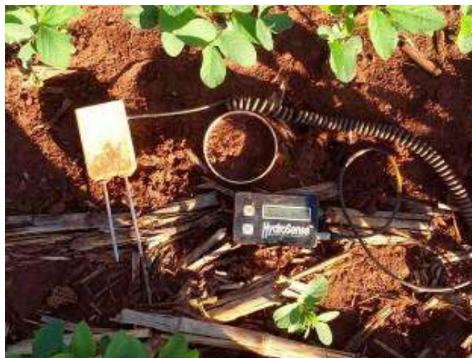
Figura 3. TDR - Hydrosense system, dispositivo portátil utilizado para a mensuração da umidade do solo.
