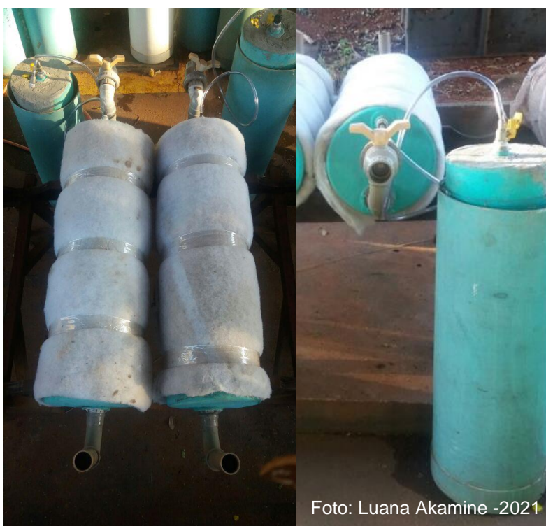
Figura 2 - Biodigestores com manta de poliéster
