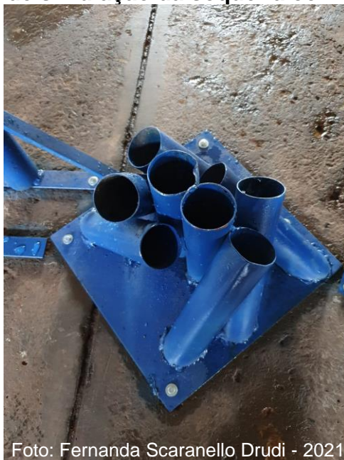
Figura 8 - Modelo de simulação da soqueira com 10 colmos - M1
