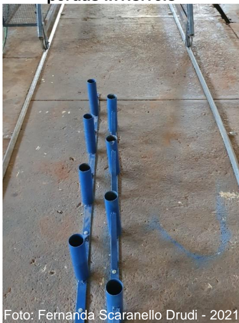
Figura 15 - Sistema para fixação dos colmos composto por para avaliação de perdas invisíveis
