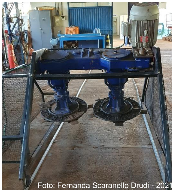
Figura 4 - Dispositivo de ensaio de corte basal de cana-de-açúcar (DECCA)
