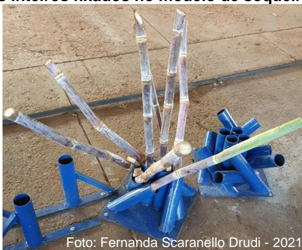
Figura 12 - Colmos inteiros fixados no modelo de soqueira antes do corte
