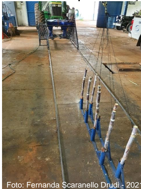
Figura 17 - Esquema para fixar os colmos para a avaliação de perdas invisíveis
