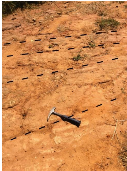
Figura 24 – Foto do ponto 6169 com fraturas de direção entre E-W a NE-SW indicados pelos tracejados.
