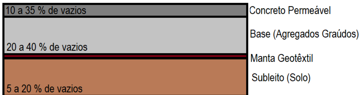
Figura 3: Esquema Pavimentos Permeáveis
