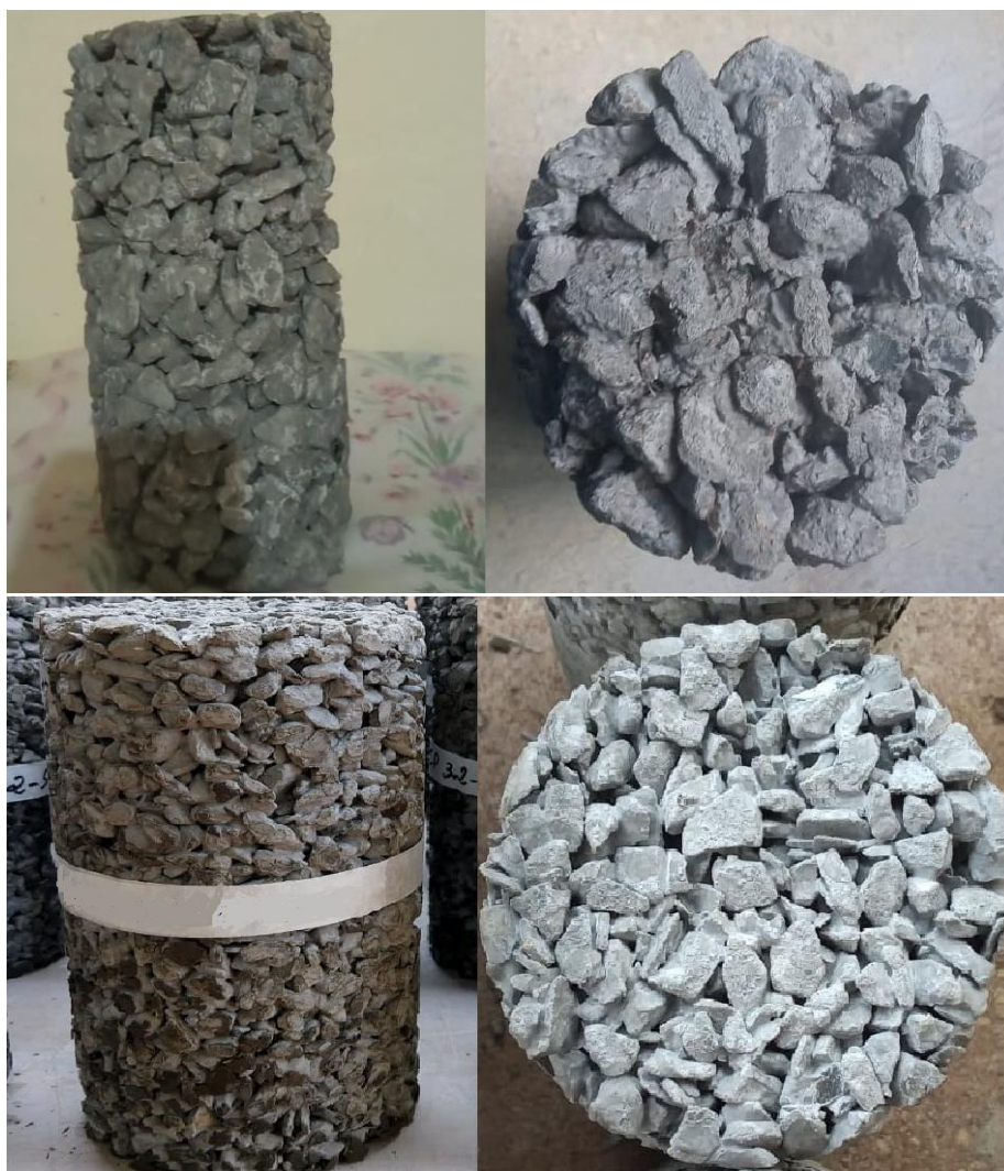
Figura 6: Comparação Visual de Traços com Diferentes Granulometrias
