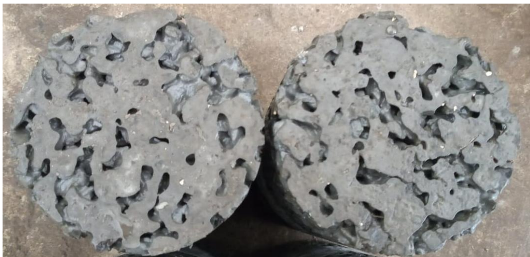
Figura 4: Colmatação Resultante do Excesso de Água na Mistura
