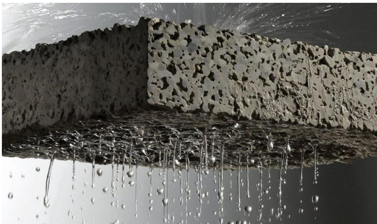
Figura 5: Concreto Permeável em Funcionamento
