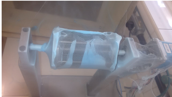
Figura 3.9: Exemplo de fiação quando a solução e/ou temperatura não são ideais para fiação da solução de Y123 com ou sem a prata.
