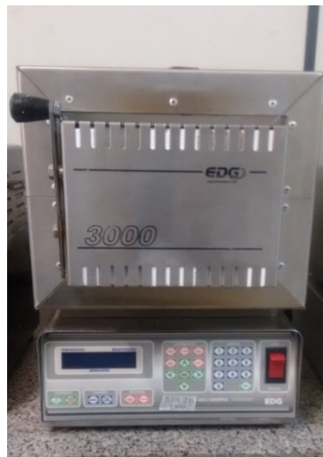
Figura 2.8: Forno do tipo mufla da EDG modelo 3000.
