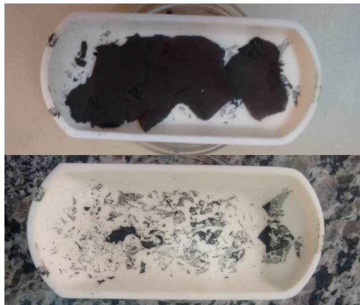
Figura 4.22: Diferença após o tratamento térmico 600^{\circ}\text{C} (superior) e 925^{\circ}\text{C} (inferior) das mantas de Y123 com prata.
