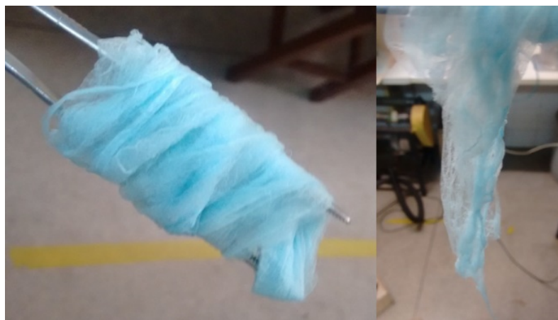
Figura 3.7: Foto mostrando a obtenção das fibras poliméricas da YAg10.
