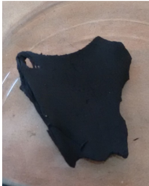
Figura 4.23: Características das mantas YAg0 após o tratamento térmico de 925^{\circ}\text{C} .
