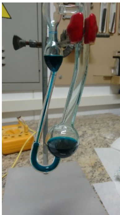
Figura 3.2: Viscosímetro capilar Cannon-Fenske, número 300.
