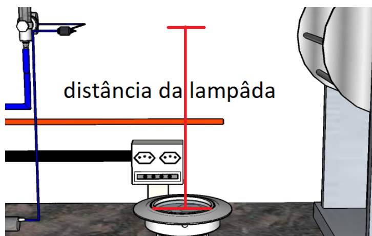
Figura 3.8: Distância da lâmpada pela técnica SBS.
