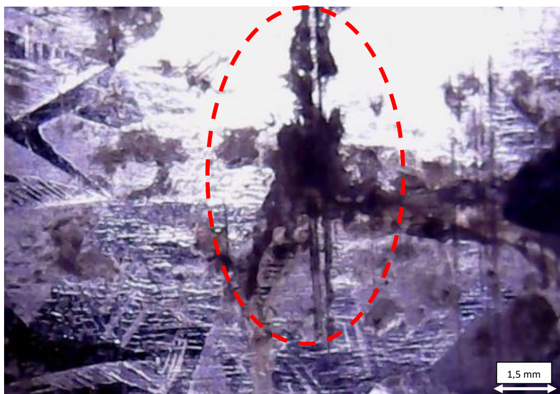
Figura 82 - Corrosão por salt spray do substrato de aluzinco sem tratamento.
