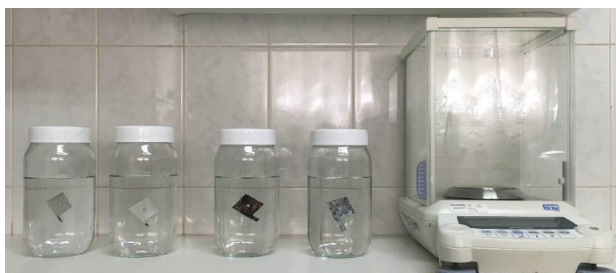
Figura 11 - Sistema criado para ensaio de corrosão por imersão.
