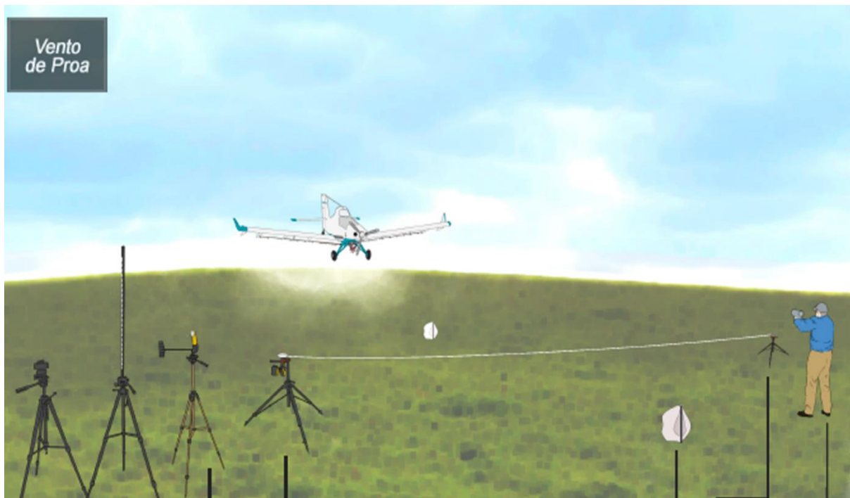
Figura 11 - Esquema gráfico para a apresentação do método espectrofotometria de fio. Voo com aeronave aplicando água e corante atóxico (Rodamina) sobre um fio coletor para avaliação da faixa da faixa de deposição
