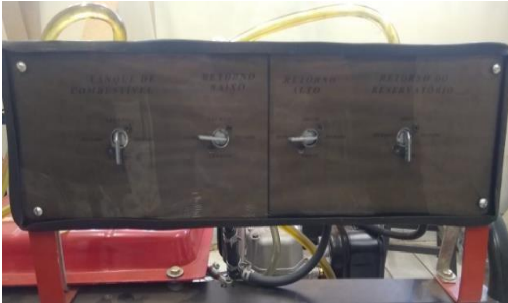
Figura 22- Conjunto de registros situados acima do motor.
