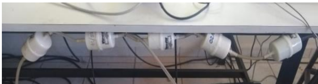
Figura 30- Conjunto de filtros em série
