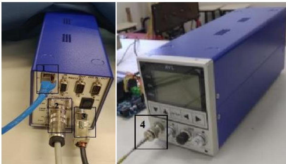
Figura 24- Disposição dos cabos módulo AVL IFEM Indi 601.
