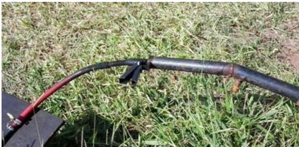
Figura 27- Sonda do opacímetro instalada na tubulação de escape.
