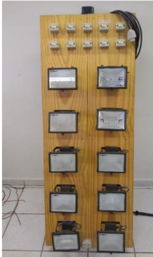
Figura 25- Bancada resistiva utilizada para os ensaios.
