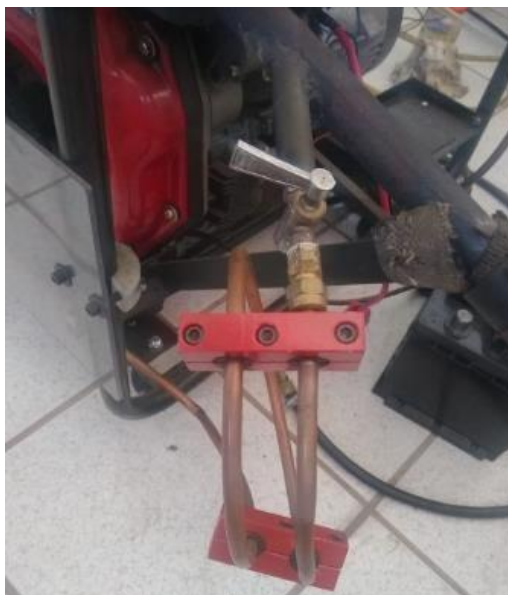
Figura 29- Sistema de tubulação para coleta de gases.
